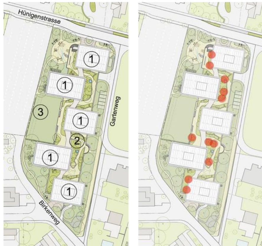
Abb. 20 Darstellung Kaskadenförmige Entwässerung (links), wichtige Bäume auf der Plattform mit Substrathöhe von 1 m (rechts), Richtprojekt 27.01.26
